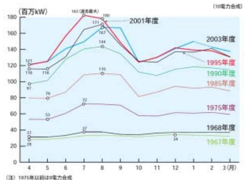
図15. 1年間の電気需要の推移(年負荷曲線)。10の電力会社の合計値を示している。[電気事業連合会「原子力・エネルギー」図面集]
