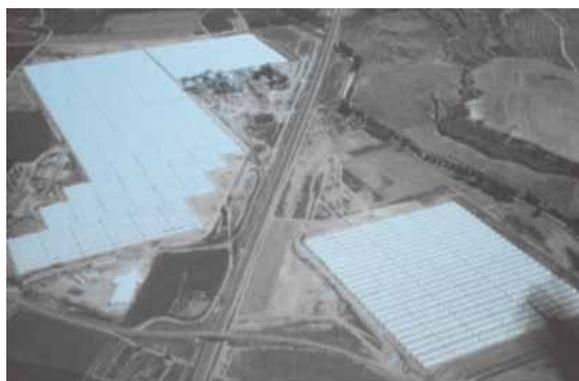
訪問したときは運悪く雨模様であったが、大規模な発電所に圧倒されたが、規模の割には設備投資額の1500万ユーロは少なく感じた。太陽熱発電設備の材料コストは太陽光発電よりも低いからである。また、日射がないときでも熱媒体に貯蔵された熱で発電が可能であるのも利点である。スペインには100MW以上の太陽熱発電所があるが、沖縄や九州南部でも検討する価値がある。
