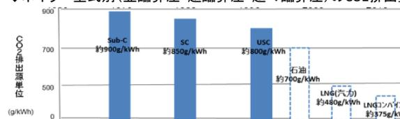
→石炭火力発電は最もCO2排出の低い化石燃料発電であるガス火力発電の約2倍のCO2を排出。
