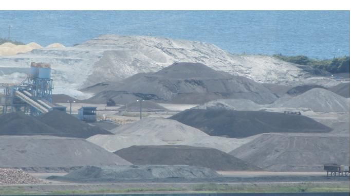
現在の JFE スチールの原料ヤードの一部。広大な土地に石炭・鉄鉱石・スラグ等が野積み状態で保管されている
