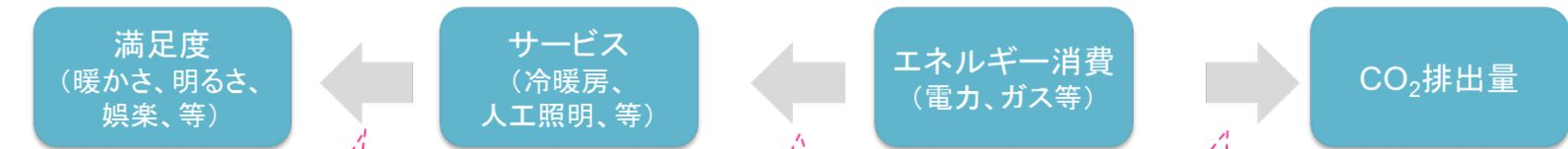
$$\text{満足度} \times \frac{\text{サービス}}{\text{満足度}} \times \frac{\text{エネルギー消費量}}{\text{サービス}} \times \frac{\text{CO}_2\text{排出量}}{\text{エネルギー消費量}} = \text{CO}_2\text{排出量}$$
